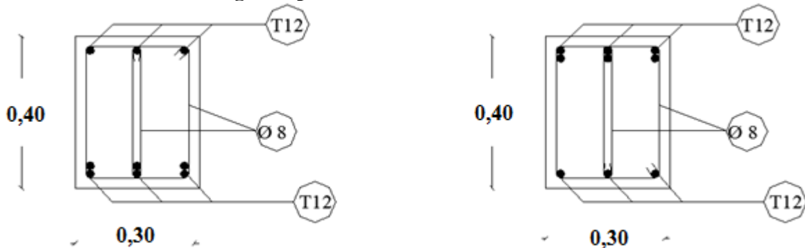
Figure V. 3: Ferrailage de la poutre secondaire.
