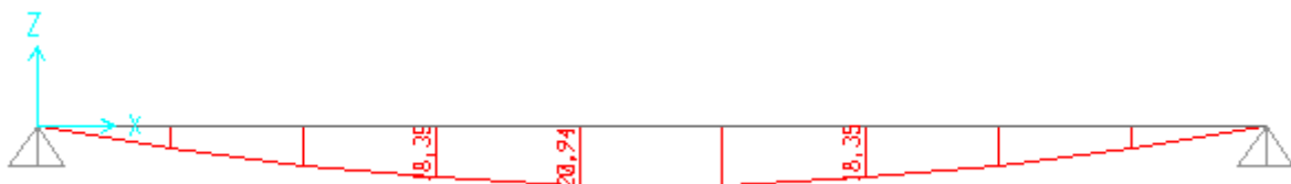
Figure III. 21: Diagramme des moments à l'ELS
