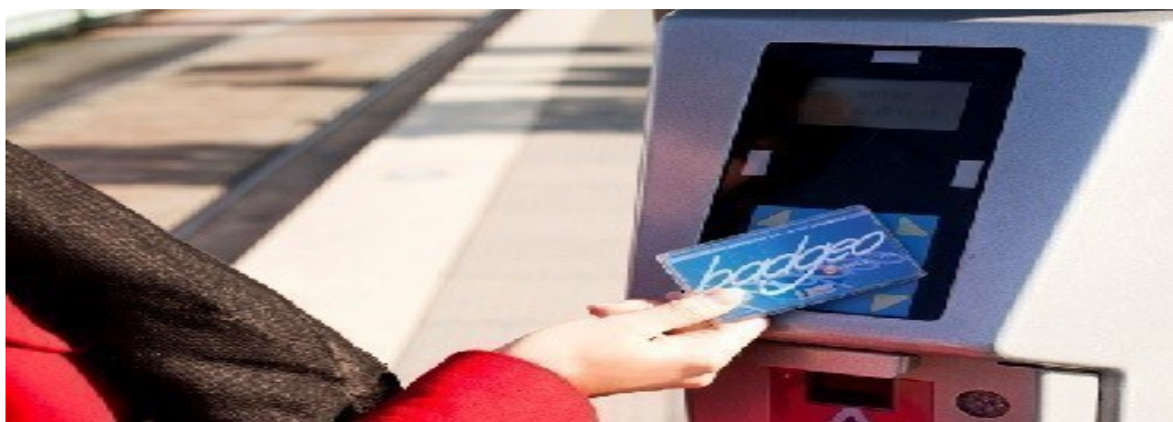
FIGURE 1.4 – Badge équipé d'une puce RFID.
