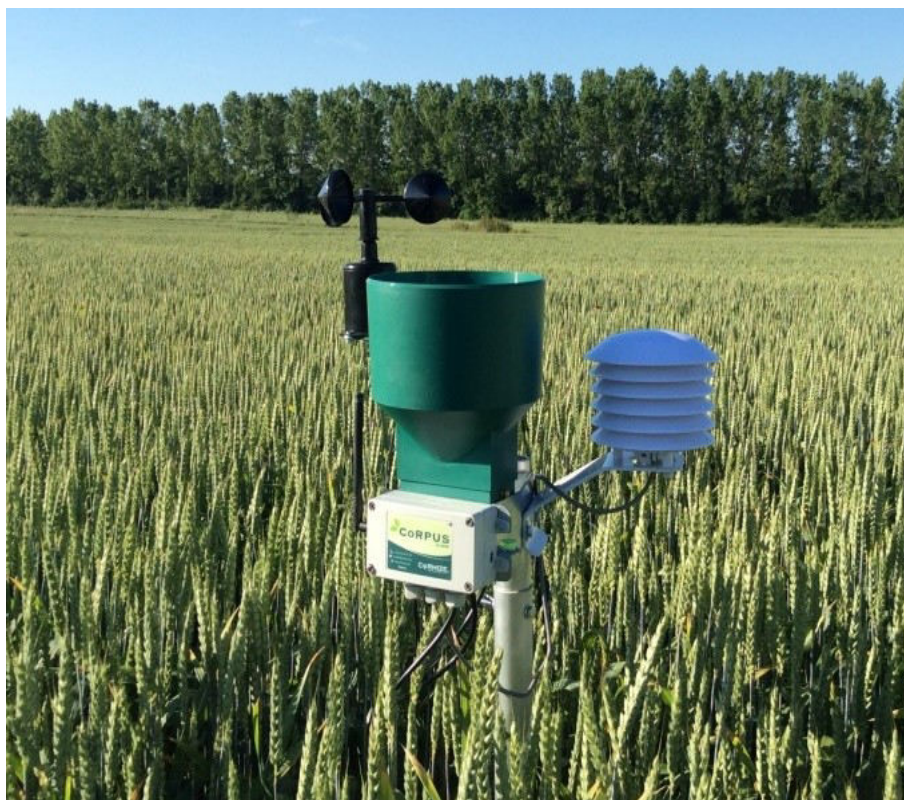
FIGURE I.6 – Capteur de température et de la vitesse du vent et taux d'humidité.
