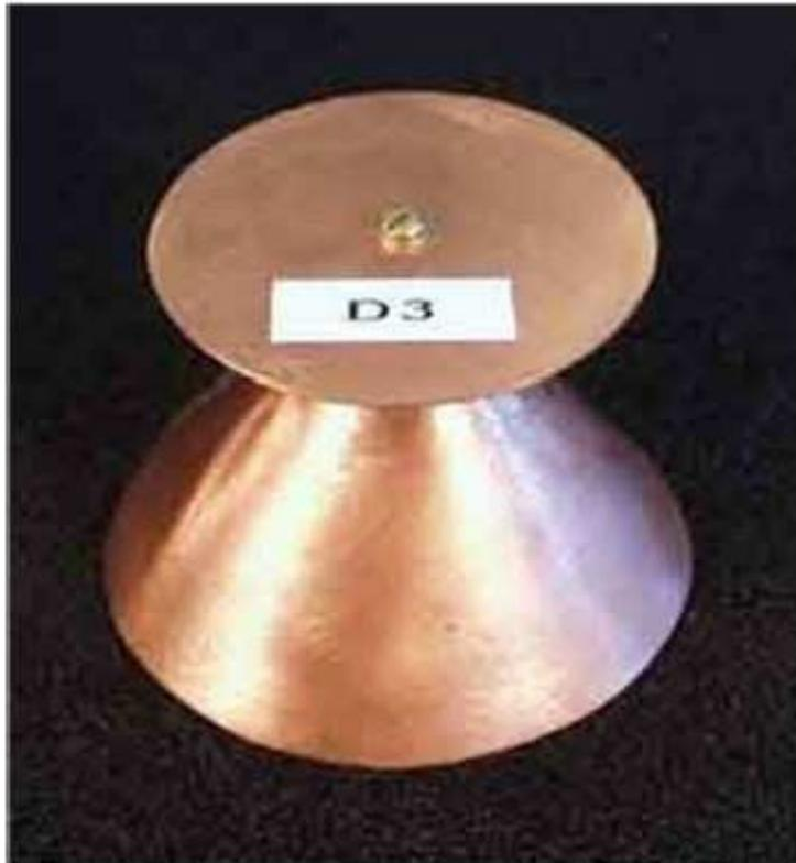
**Figure II. 15 : Exemple de réalisation d'une antenne discone.**
