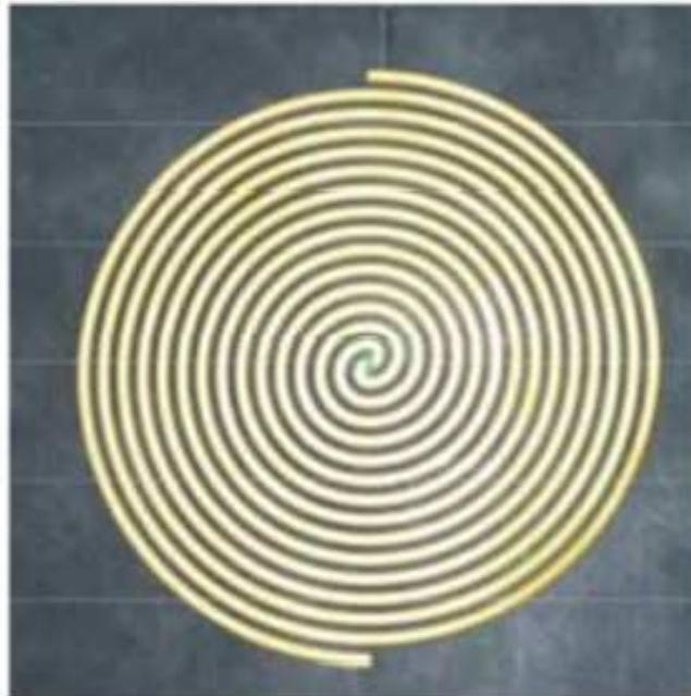
**Figure II. 12 : L'antenne spirale d'Archimède.**
