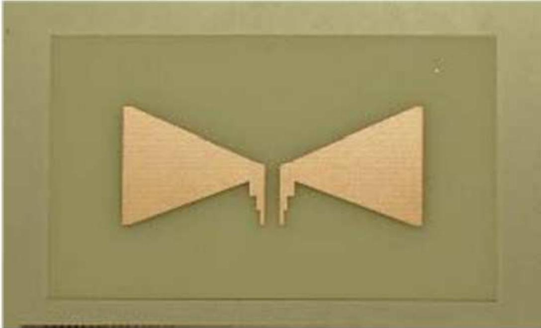
**Figure II. 16 : Exemple de réalisation d'une antenne papillon.**
