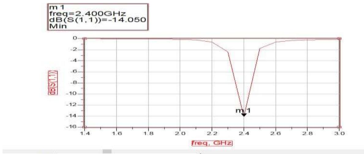
Figure II 8:Simulation du coefficient optimisé
