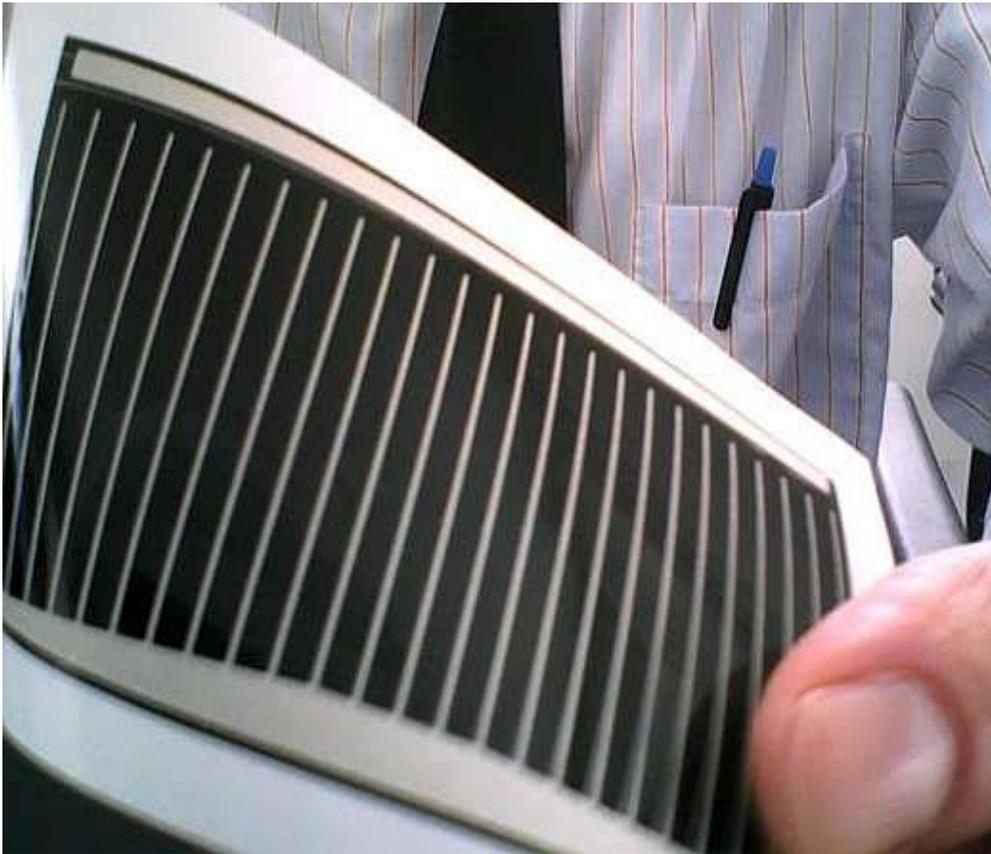
**Figure11 : cellules photovoltaïques au CIGS**
