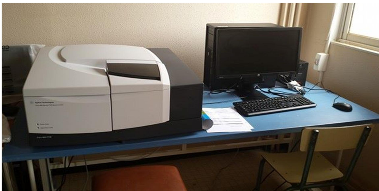
Figure II 2 : Spectromètre utilisés dans nôtres étude FTIR/NIR Agilent Carry 600 Série FTIR
