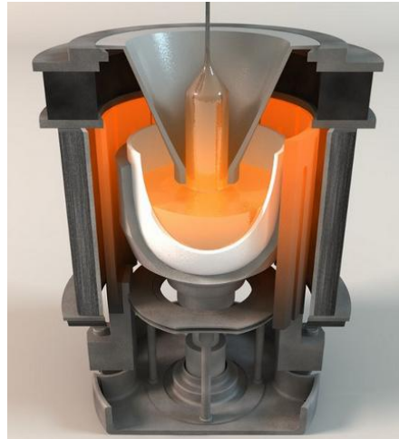
Figure II-3 : Tirage d'un lingot de Silicium par la méthode Czochralski [15]
