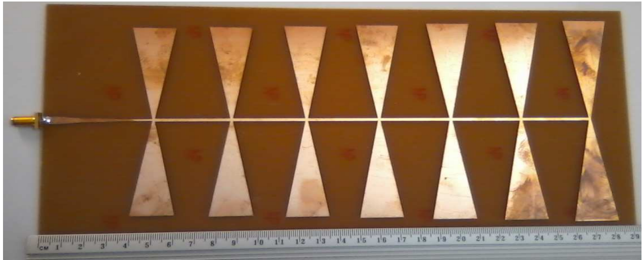
Figure V.6. Le prototype réalisé du réseau d'antennes log périodiques de type nœud-papillon fonctionnant dans la bande C [3.7-4.2] GHz.
