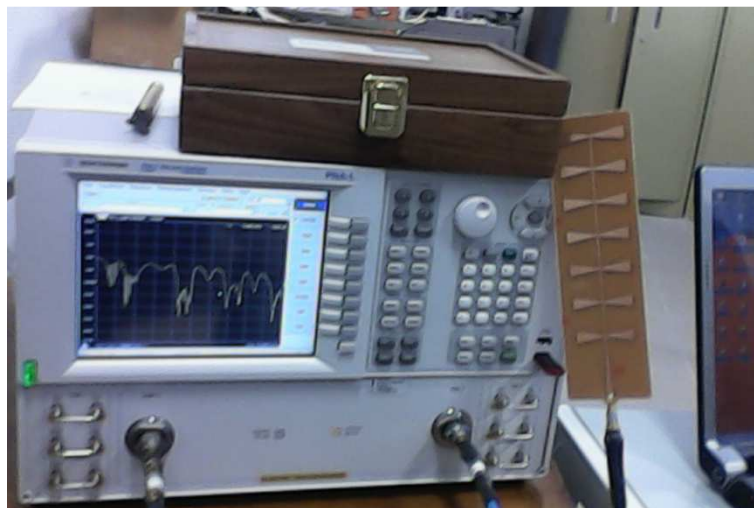
Figure V.1. Mesure du coefficient de réflexion à l'entrée de notre réseau d'antennes à l'aide d'un analyseur de réseau vectoriel.
