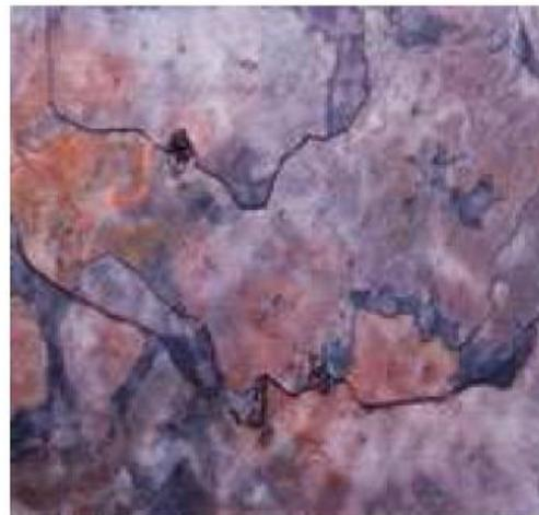
Figure 6 : corrosion sous contrainte
