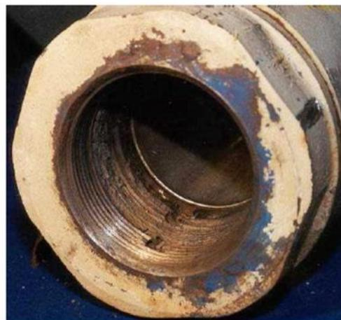
**Figure 4 :** Corrosion Galvanisée
