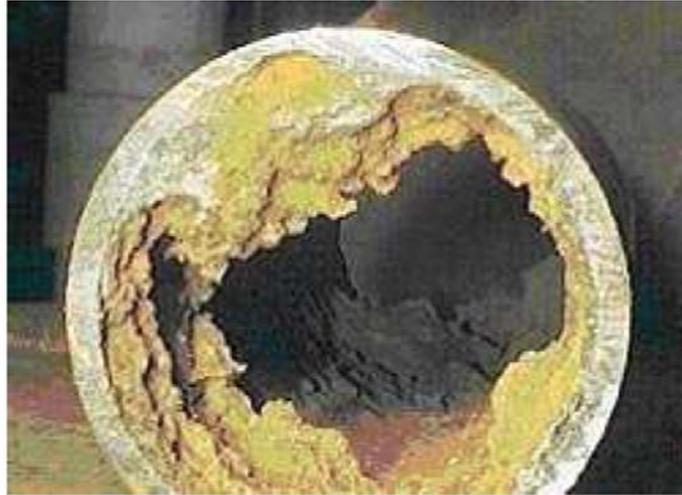
**Figure 3 :** corrosion caverneuse
