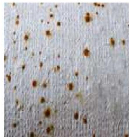
**Figure 2** : corrosion par piqûres
