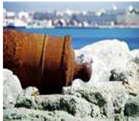
**Figure1** : Corrosion Généralisée
