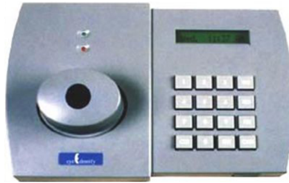
FIGURE 2.1: Scanner rétinien de EyeDentify
