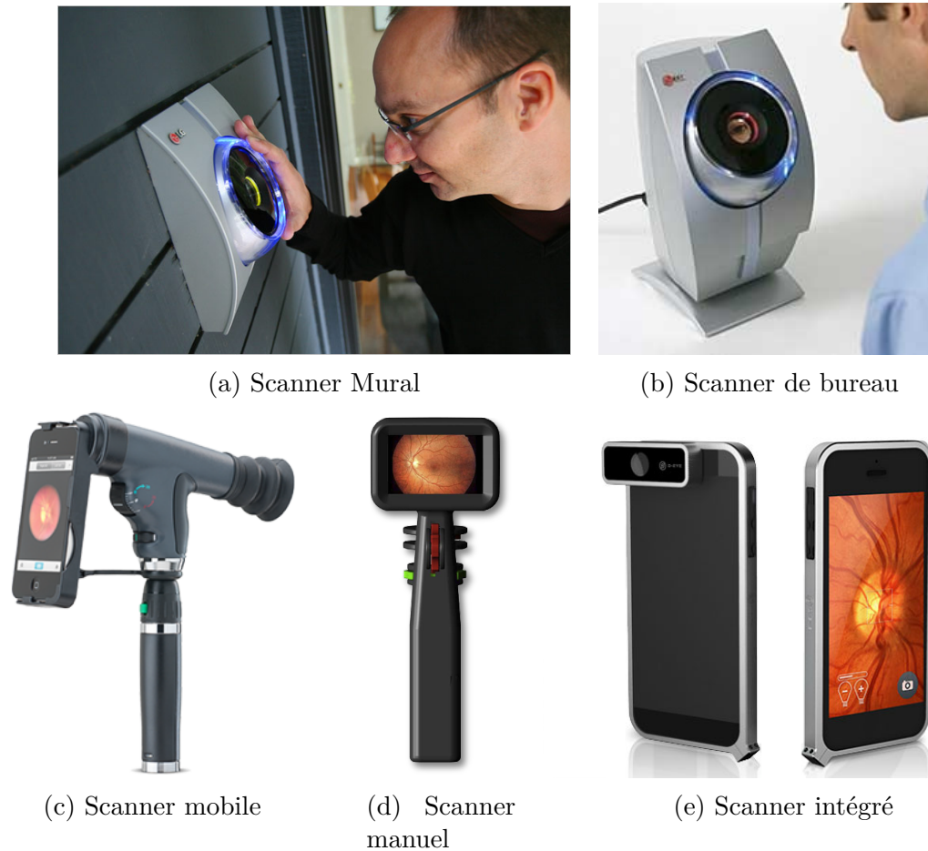
FIGURE 2.3: Scanners biométriques rétiniens ( Abràmoff et al., 2010 )
