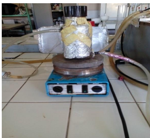
Figure 1 : montage de préparation des catalyseurs bimétalliques.
