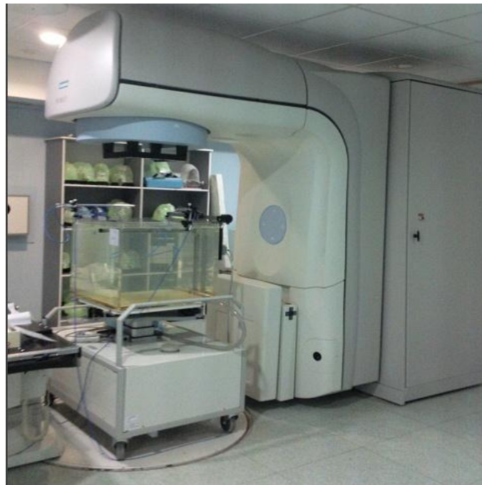
Fig. VI.9 Cuve à eau en cours de montage
