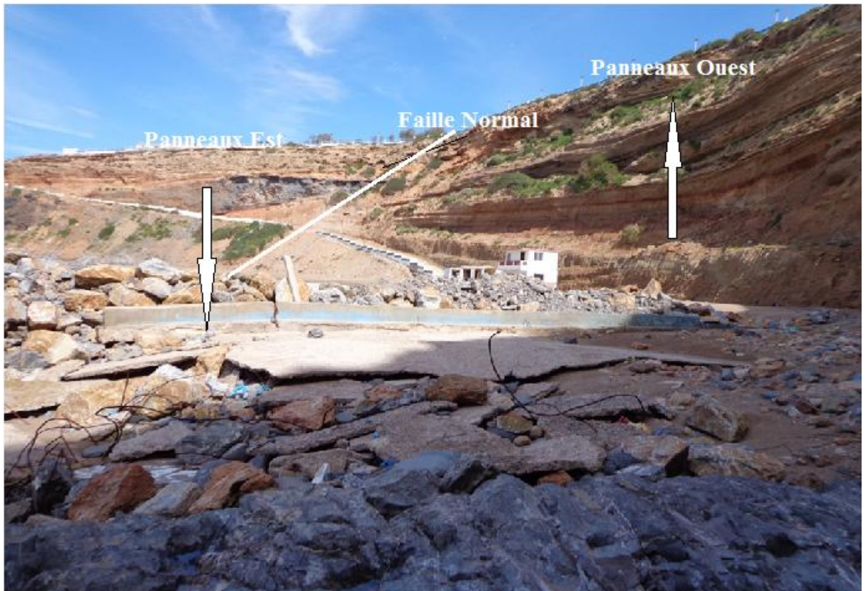
Fig.7 : photo panoramique montrant les deux panneaux et le sens de la faille normale.
