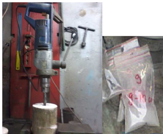
Photo III.21 : Grignotage et poudres recueillies sur les éprouvettes exposées insitu.
