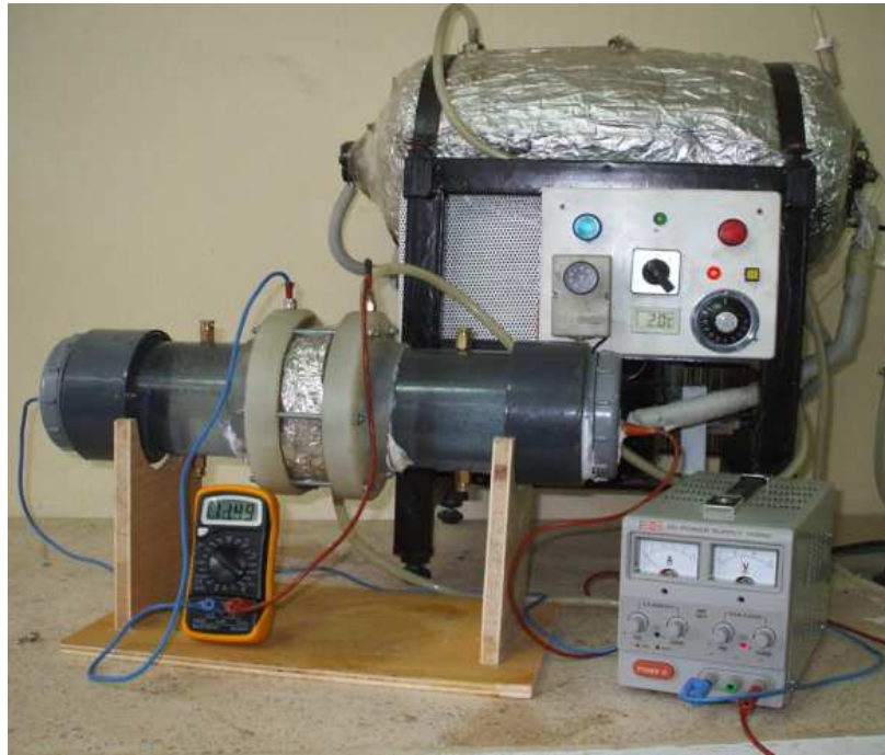
Photo III.11 : Essai de migration muni du dispositif chaud et froid.
