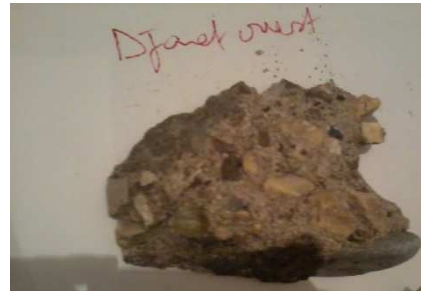
Photo V.1 : Fragments de béton du môle de Djanet.
