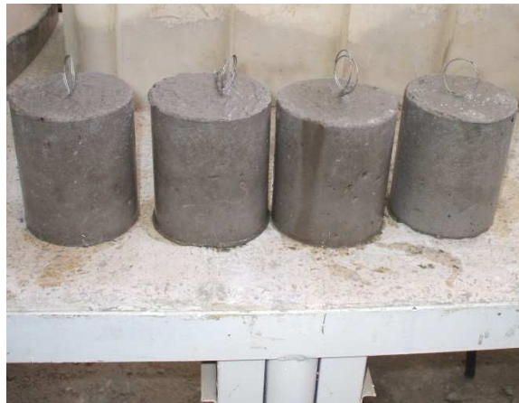
Photo III.18 : Eprouvettes de béton 11x11 cm
