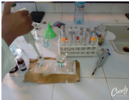
Photo 18: Préparation des solutions (Original) . Photo 19: lecture au spectrophotomètre (Original) .
