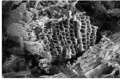
Figure 3 : Structure du charbon actif vu sous un microscope électronique
