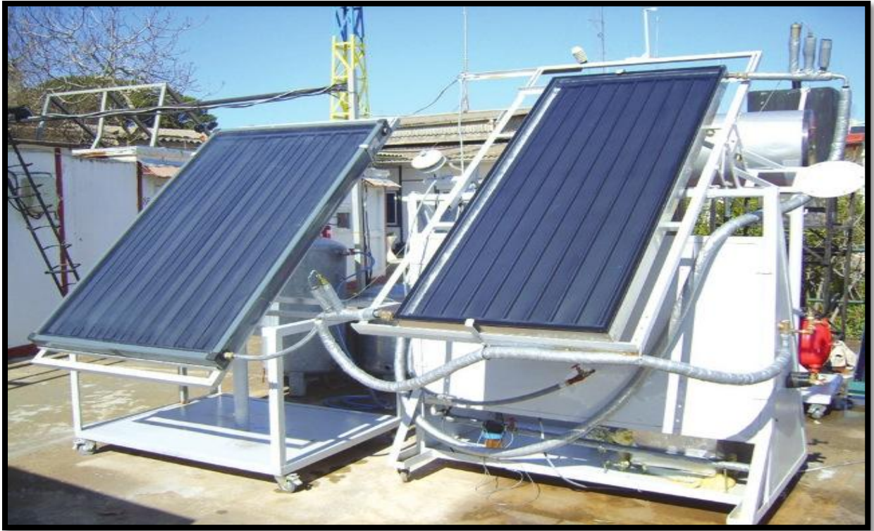
Fig II.8: Photo représentant un Chauffe-eau solaire
