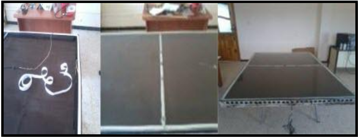
Fig IV.6: Photos représentent l'établissement du verre à la face auparavant du capteur à l'aide de colle et de joint
