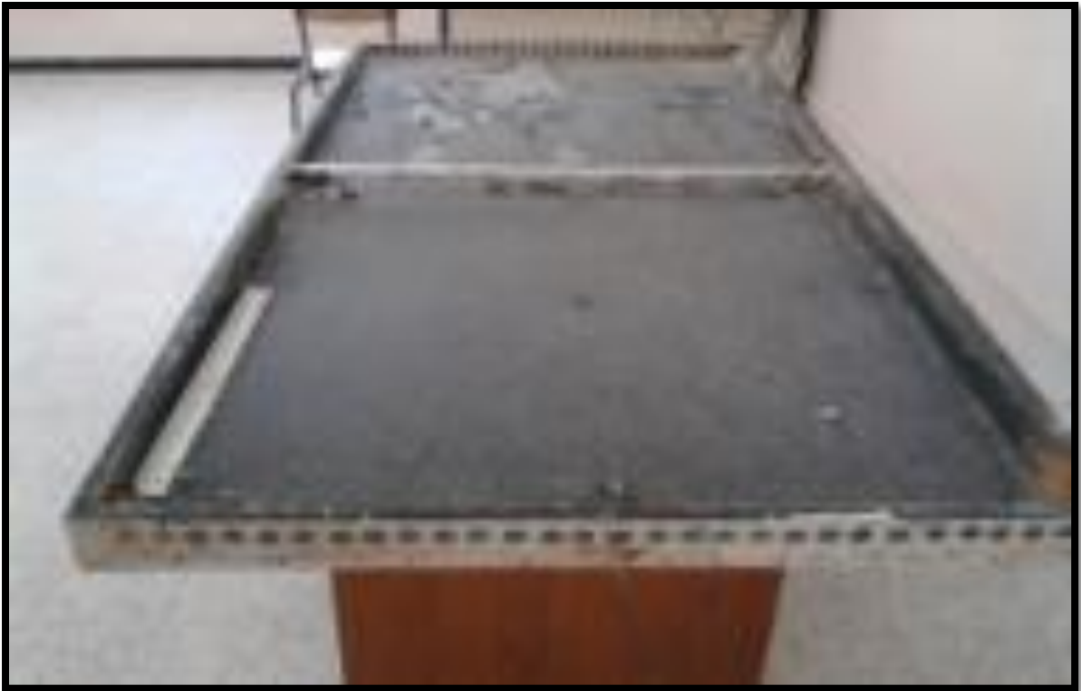
Fig IV.2: Photo représente le grattage de la peinture de la plaque absorbante
