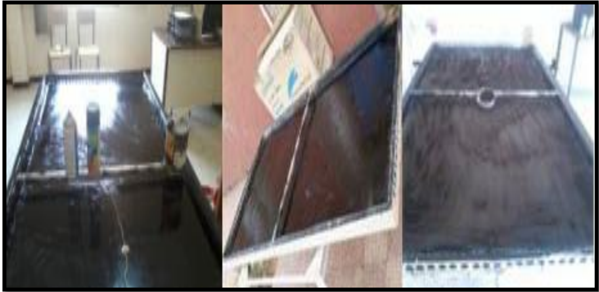
Fig IV.4: Photos représentent la pigmentation de l'absorbeur en noir mat
