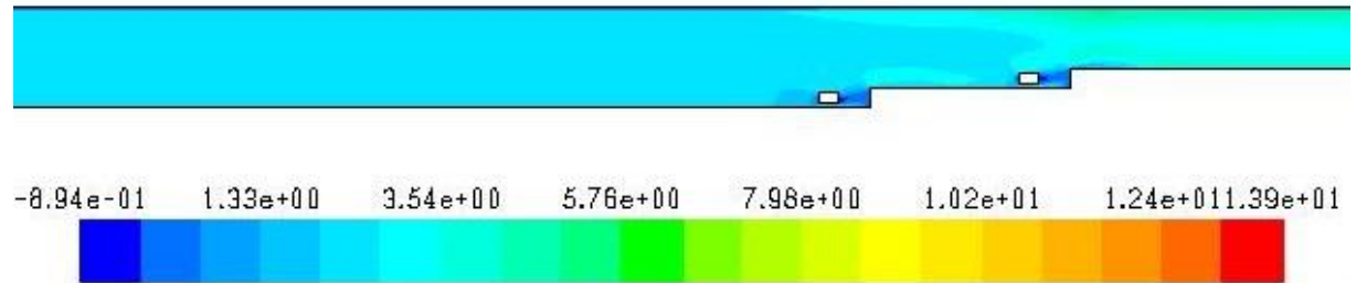
Figure IV. 30- contour de vitesse axiale pour le 1 er cas à Re = 30000 .
