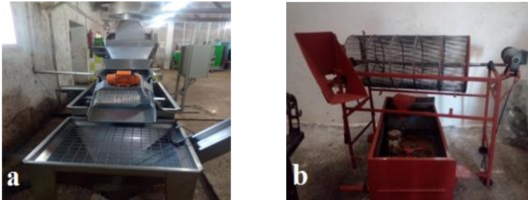
Photo 08: Machine pour lavage des olives (a) et effeuillage des olives (b) (originale)
