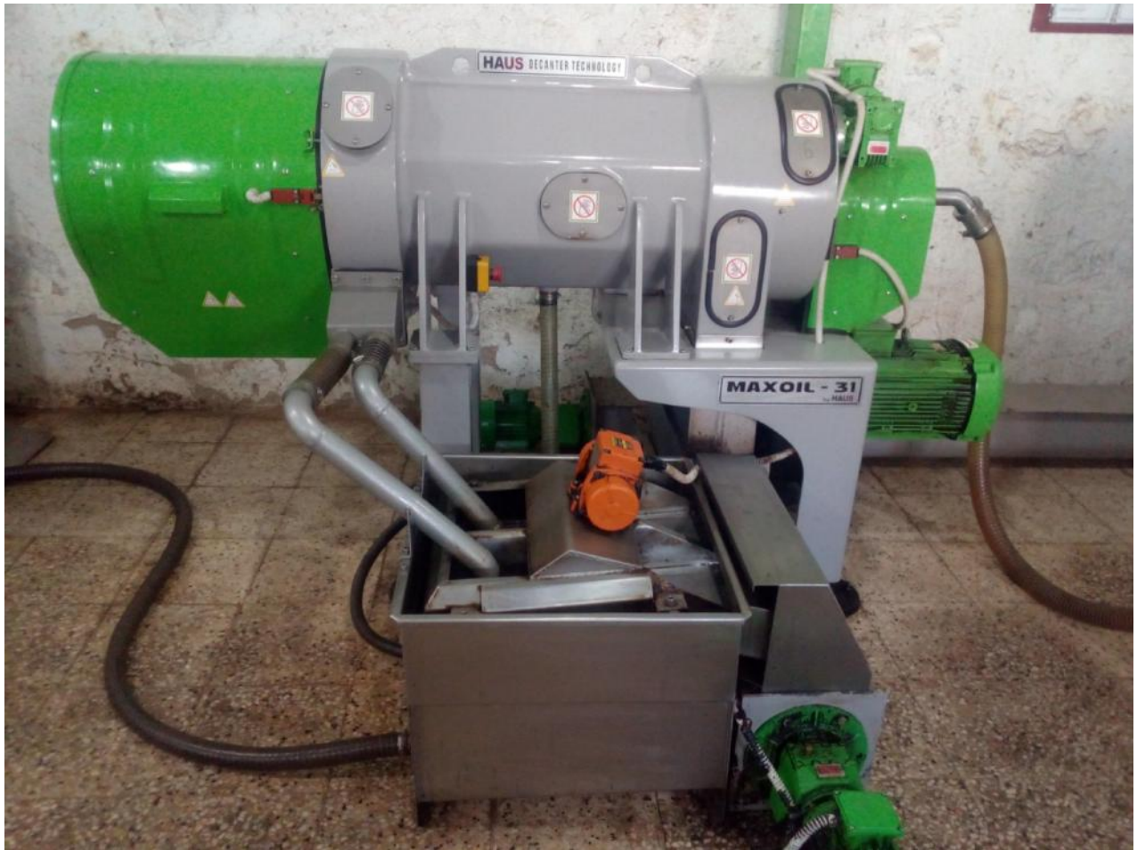
Photo 05 : Processus d'extraction des huiles d'olives par centrifugation 3 phases (originale)
