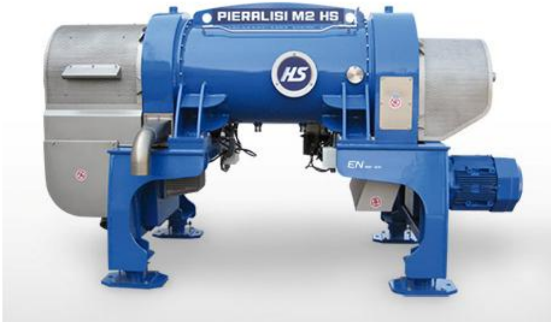
Photo 06 : Processus d'extraction des huiles d'olives par centrifugation 2 phases (anonyme)
