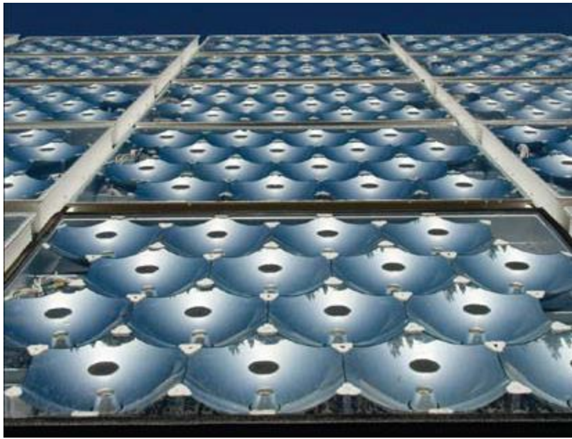
Fig.1.10 : Prototype de panneau solaire tri-jonctions à concentration
