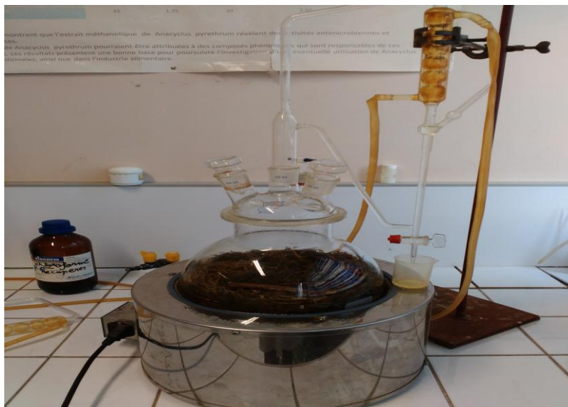
Figure 2 : Montage de l'hydrodistillation type Clevenger.
