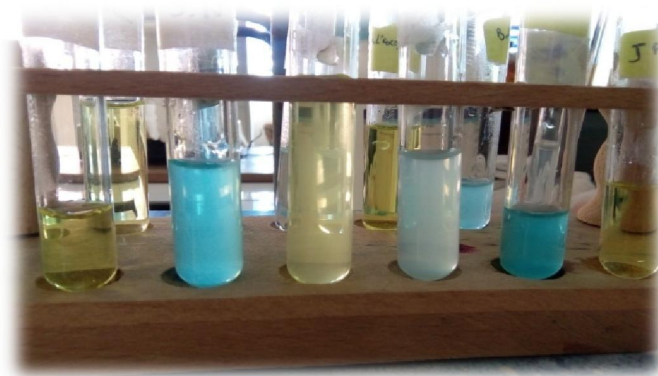
Figure 19 : Colorants séparés par chromatographie sur colonne
