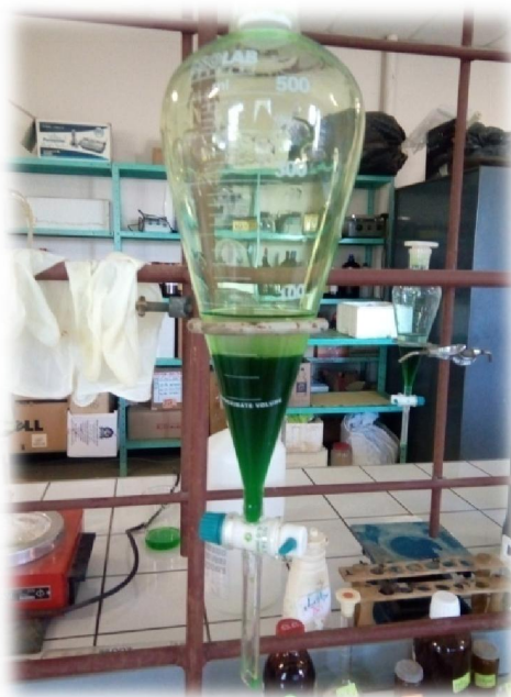
Figure 13 : Extraction liquide-liquide du sirop de menthe
