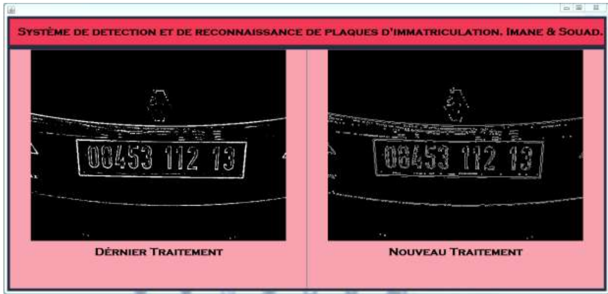
Figure 13: Fenêtre transformation de Canny.
