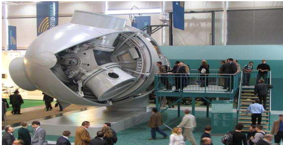
Figure.1.16: Schème d'un retord et son moyeu [12]
