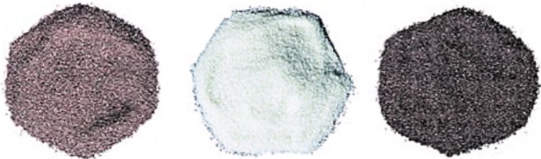
Figure III.2: Photographie du corindon brun, blanc et semi-friable respectivement. [43]
