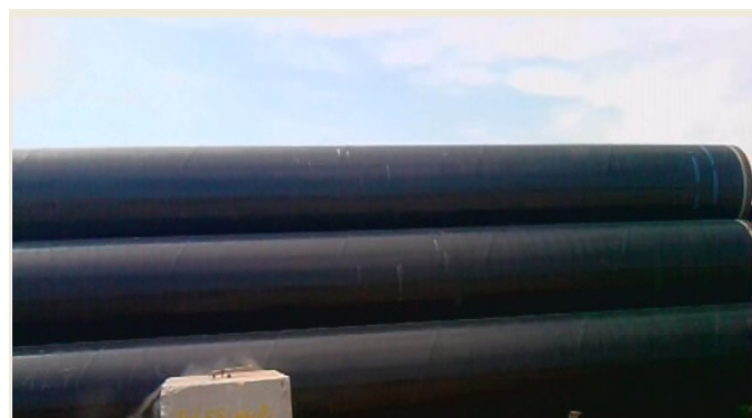
Figure II.23 : revêtement polyuréthane (usine)
