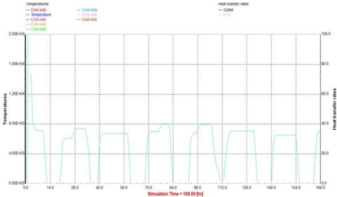
Figure VI.11 : Représentation de la consommation d'énergie d'appoint avec 3 capteur de surface total 6 mètre
