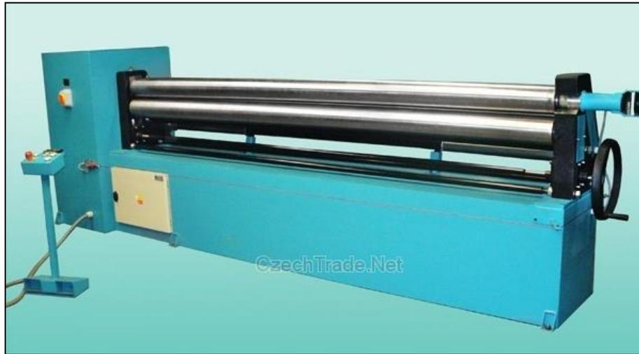
**Fig. 1.2 Cintreuse de tôle électrique**
