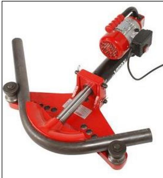
**Fig. 1.5 Cintreuse de tube électrique**
