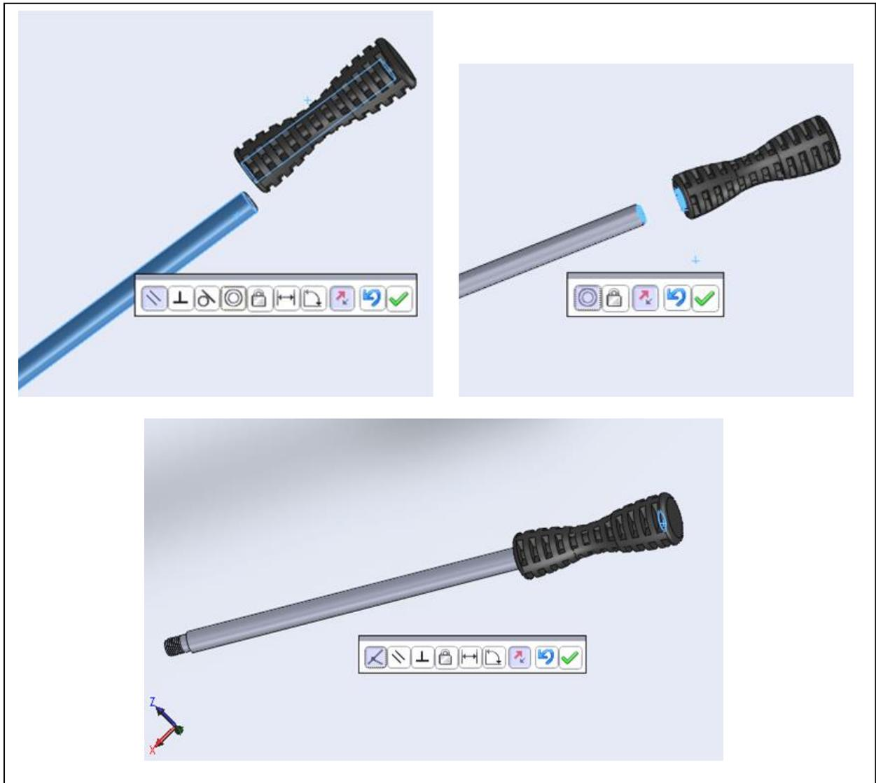
**Fig. 3.8 Contraintes parallèle, coaxiale et coïncidente entre la pièce8 et la pièce4**
