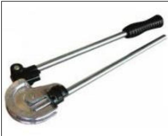
**Fig. 1.3 Cintreuse de tube manuelle**
