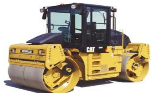
Figure I.13 : Compacteur vibrant à deux cylindres [2]
