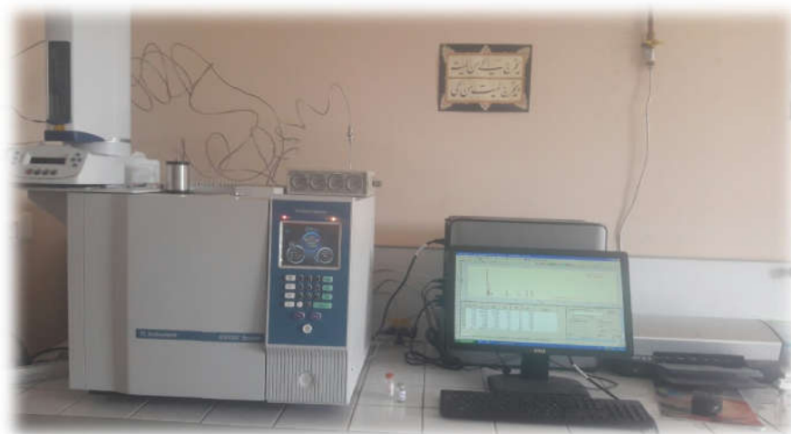
Figure 7: chromatographie en phase gaz(LCSCO, Tlemcen).
