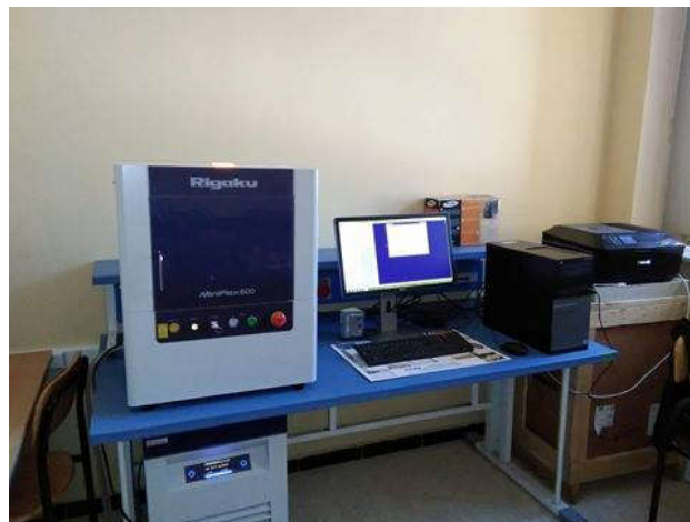
Figure 3 : Appareil DRX MINIFLEX 600(LCSCO, Tlemcen).
