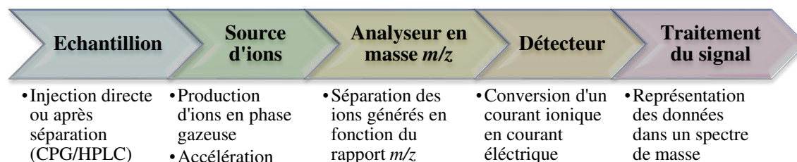
Figure 50 : Principales étapes du fonctionnement d'un spectromètre de masse
