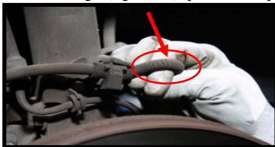
Figure 3.4 : les craquelures du caoutchouc [14].
