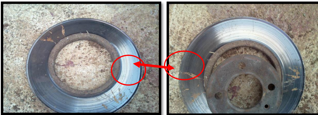
Figure 3.14 : Disque endommagé par le fer d'une plaquette.
