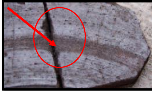
Figure 3.7: Usure non-uniforme sur une plaquette [15].
