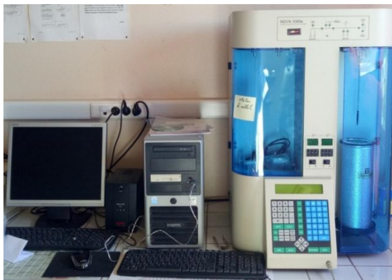
Figure II. 3. Appareil NOVA 1000e employé pour les mesures BET.
