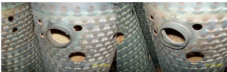
Fig.2.35.les tubes à flammes usés [3]
