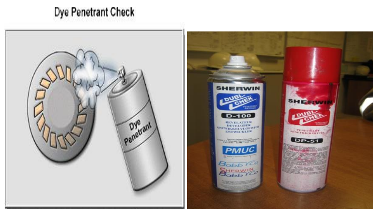
Fig.2.39.méthode par ressuage (révélateur et pénétrant) [3]
