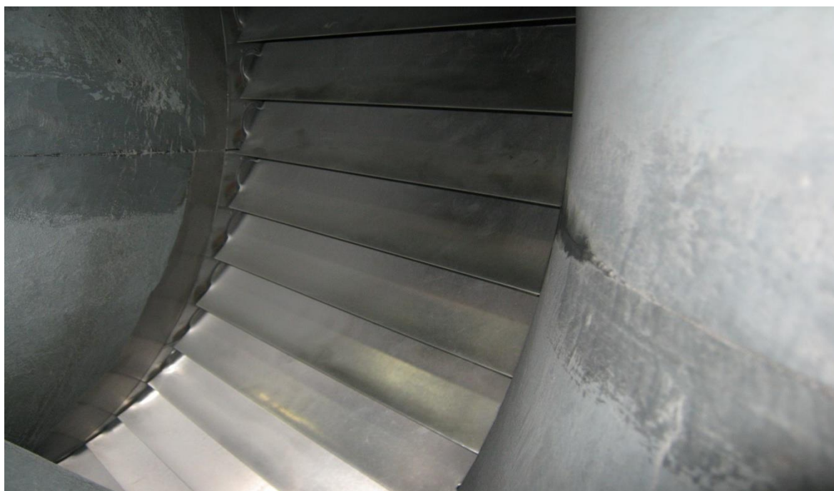
Fig.2.18. les IGV dans le cas fermé [3]
