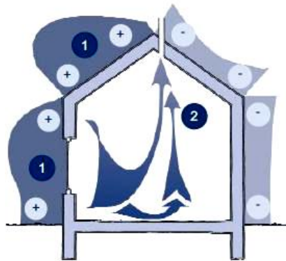
Figure III.6: Pression du vent sur un bâtiment
