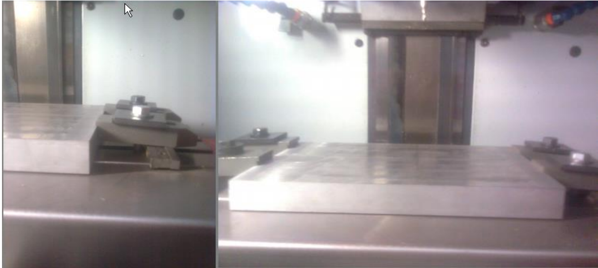
Figure-5.3- Fixation de la plaque par les pinces
