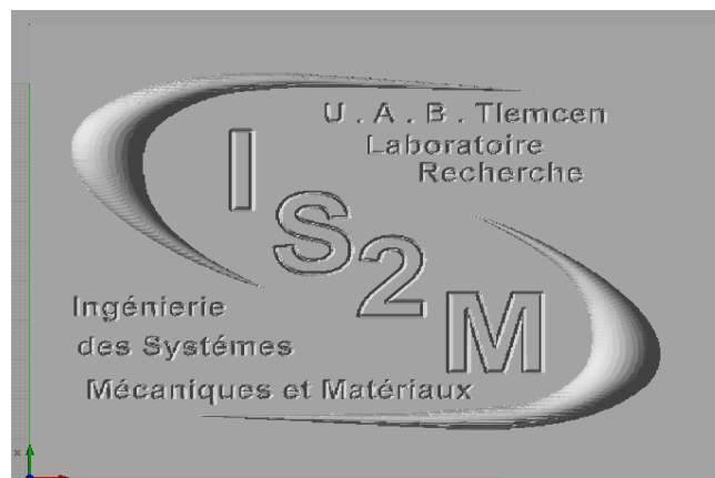
Figure-4.30- Résultat de simulation de parcours d’outil de la gravure S5
