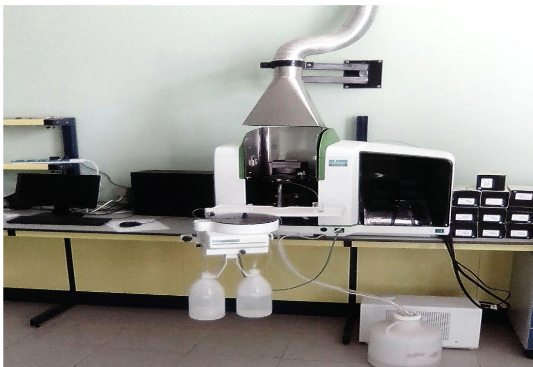
Figure III.7 : Les spectromètres d'absorption atomique Perkin Elmer 900
