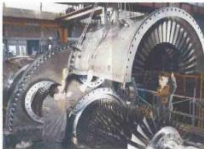
Figure (III - 8) : stator du compresseur
