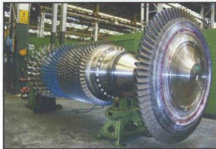
Figure (III - 7) Rotor du compresseur axial
