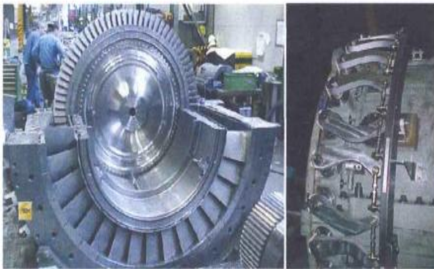
Figure (III-14): Directrice du deuxième étage
