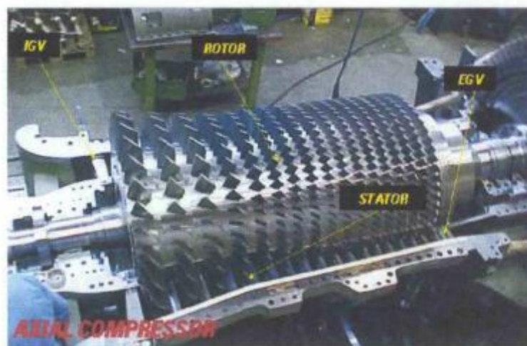
Figure (III -6) le compresseur axial
