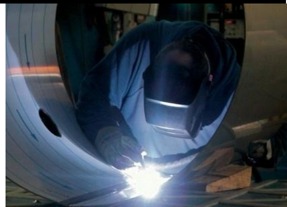
Figure 06 Soudage TIG (Tungsten Inert Gas)
