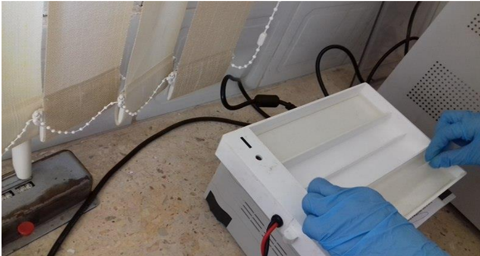
Figure 21: Préparation de la chambre de migration
