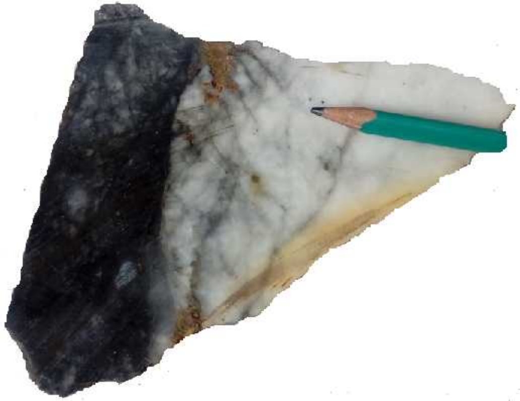
Figure. IV-1 : Aspect macroscopique montrant le contact entre le quartz blanc et le quartz gris ZF 9.
