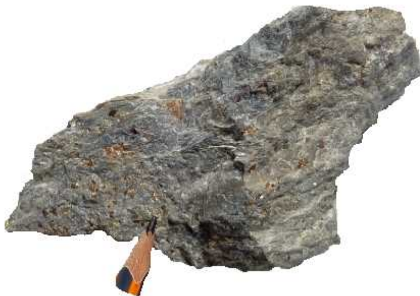
Figure. IV-5 : Bérise (métasomatite) grise verdâtre, massive, riche en petits cristaux de pyrite disséminés et recoupée par des veines de quartz gris, remplies parfois aussi de pyrite ZF 8.
