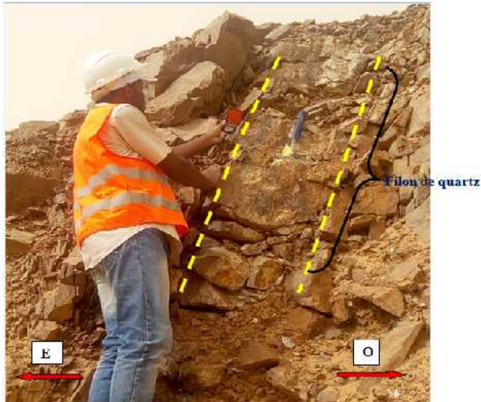
Figure .III-9 : filon de quartz recoupé par une faille post minéralisation avec la bérésites.
