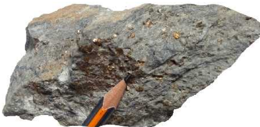
Figure. IV-5 : Bérise (métasomatite) grise verdâtre, massive, riche en petits cristaux de pyrite disséminés et recoupée par des veines de quartz gris, remplies parfois aussi de pyrite ZF 8.
