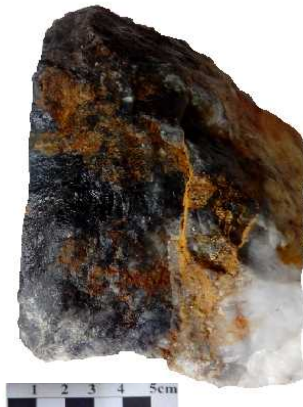
Figure. IV-4 : Échantillon de quartz noir massif peu déformé. ZF 8.
