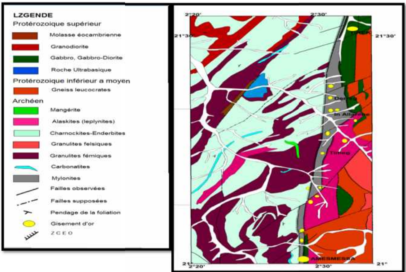
Figure. II-16 : Carte géologique et structurale de la région d'Amessmessa et de l'In Ouzzal Sud, issue des travaux de terrain et du traitement de l'image satellitaire Landsat 7 ETM+ montrant les structures en dômes et bassins. La trajectoire de la foliation et les accidents (d'après ORGM).
