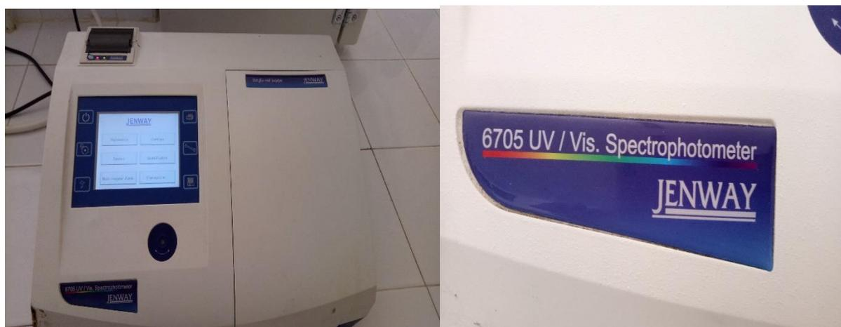
**Figure n°7 :** le spectrophotomètre JENWAY pour mesurer la DO
