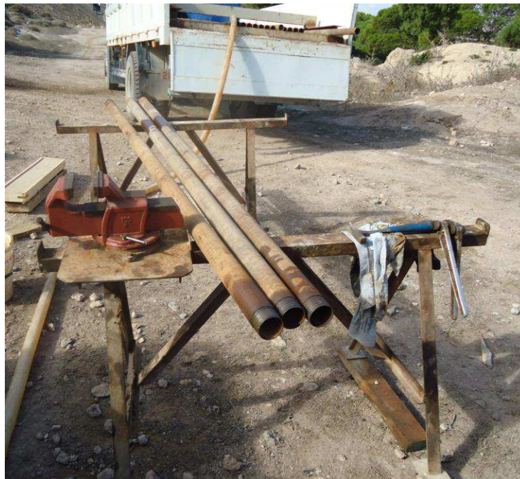
Figure 11 : tiges de sondage carotté (3 mètres de longueur, photo Boucif)
