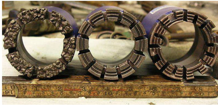
Figure 12 : différents types de couronnes diamantées (photo Boucif)
