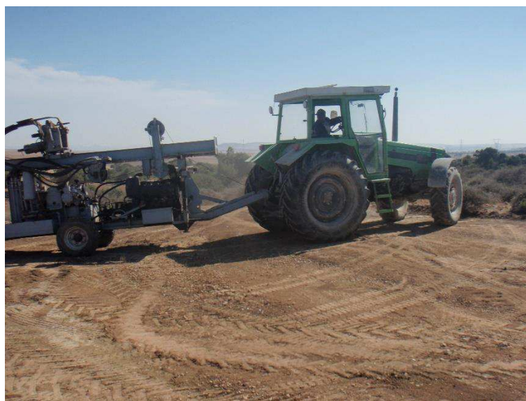
Figure 10 : Sondeuse d'exploration de la société Knauf
