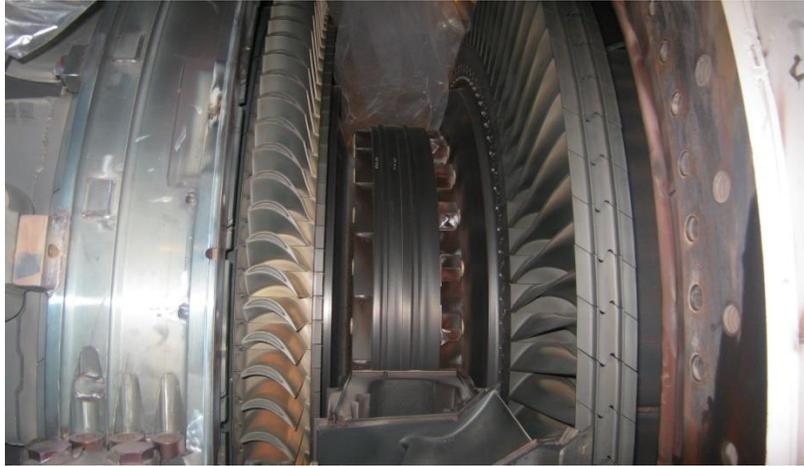
**Fig. I.19 Ensemble rotor de la turbine**
