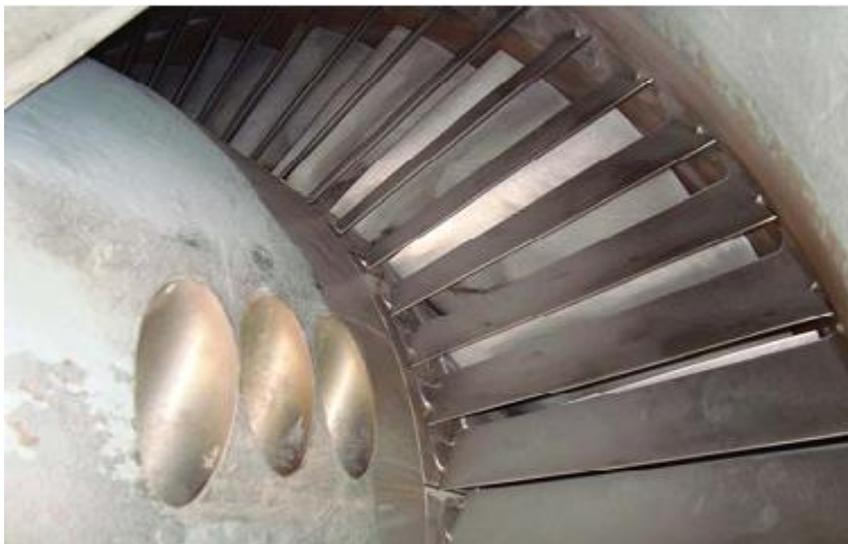
**Fig. I.7 La soupape d'entrer de Gas**
