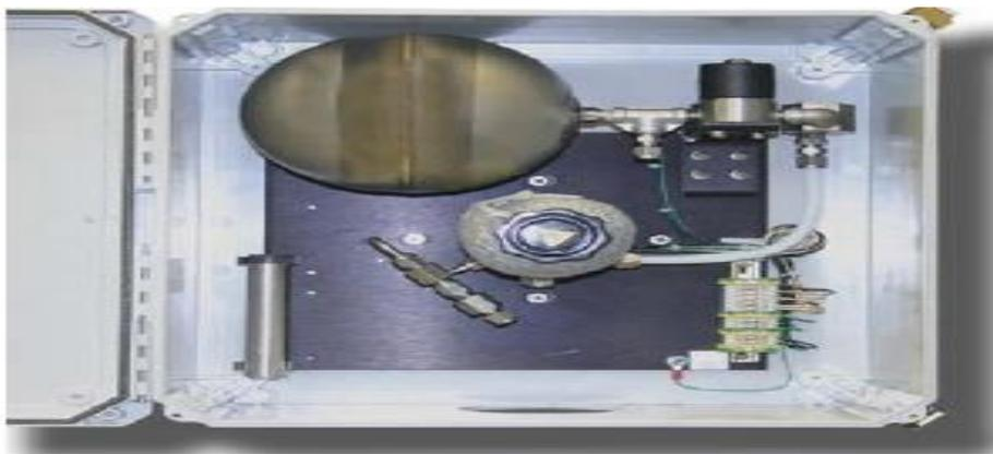
**Fig. IV.17** Sonde d'échantillonnage du gaz à l'échappement turbine
