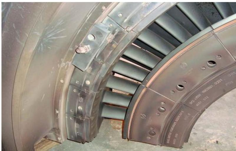
**Fig. I.18 Distributeur et diaphragme de deuxième étage**
