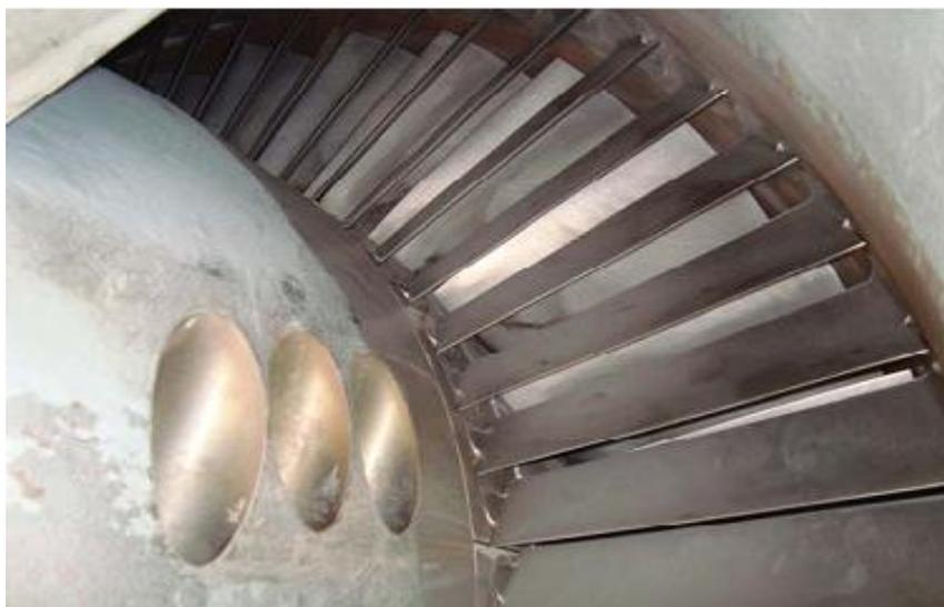
**Fig. I.7 Les IGV (Intel Gaz Valve)**
