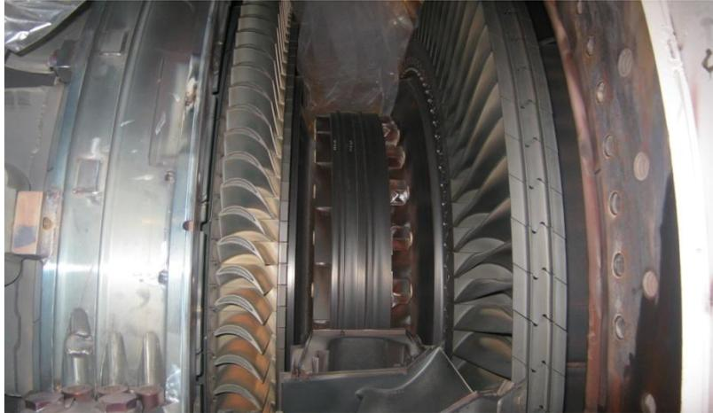
Fig. I.19 Ensemble rotor de la turbine
