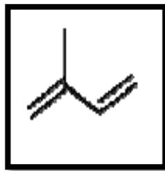
Figure 12 : Structure chimique d'isoprène.
