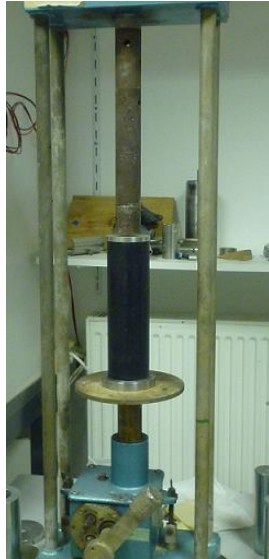
Figure 4.4 (a) Compactage statique des éprouvettes de limon
