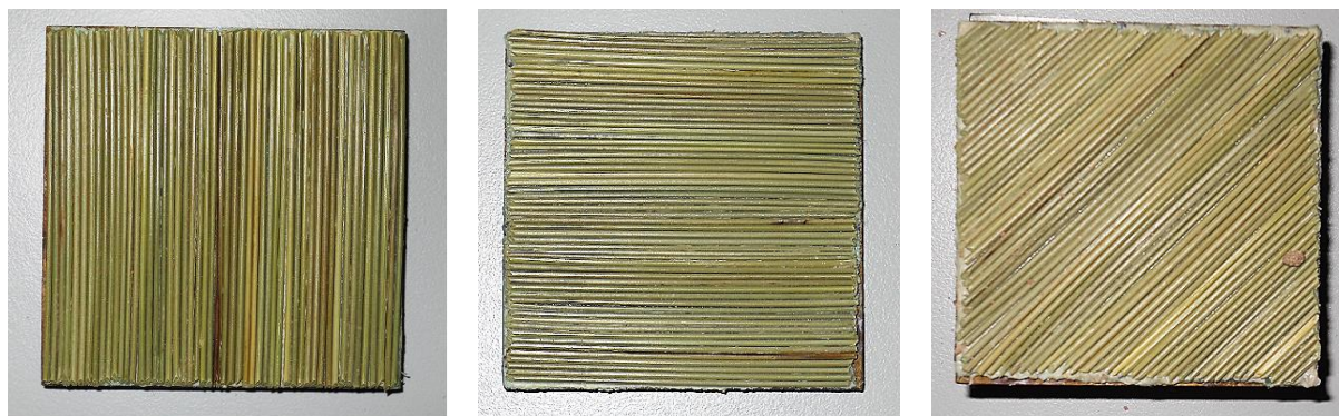
Figure 3.14 Etat des feuilles d'Alfa après l'essai du cisaillement
