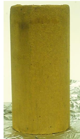
Figure 4.4 (b) Eprouvette de limon après compactage statique
