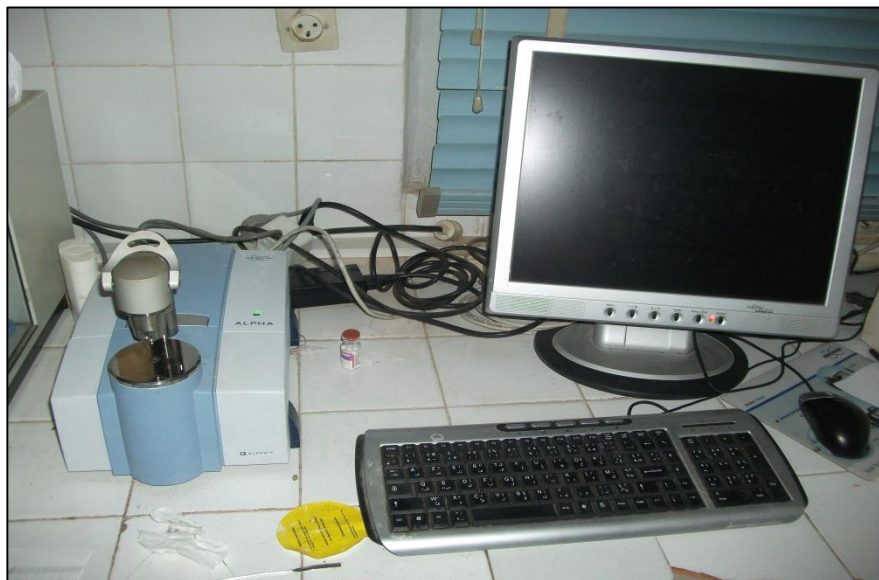
Figure 3.7 : Spectromètre infrarouge ALPHA Bruker (Laboratoire de Chimie Des Polymères-LCP- Université d'Oran, Algérie).
