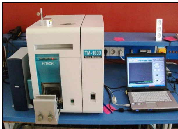
Figure 3.11 : Microscopie électronique à balayage type HIRACHI-TM1000 (Laboratoire LRM, Faculté des Sciences, Université Abou Bekr Belkaid, Tlemcen, Algérie).
