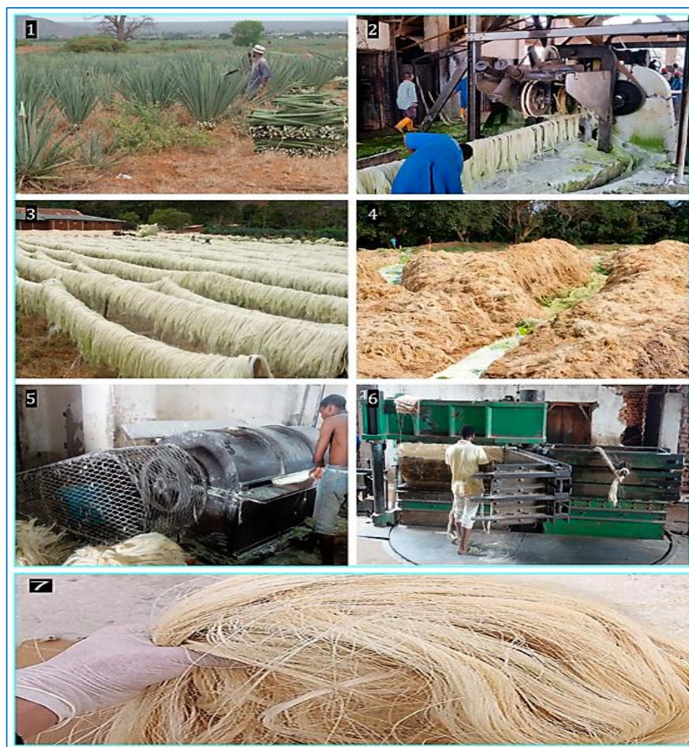
Figure 1.13 : Processus principales de production des fibres de sisal [NER 16] [BEL 13].
