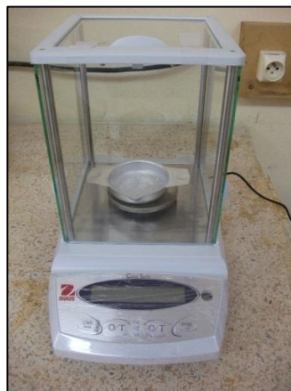
Figure 3.12 : Balance analytique type OHAUS avec une précision de pesée de 0,001g (Laboratoire EOLE, Université Abou Bekr Belkaid, Tlemcen, Algérie).
