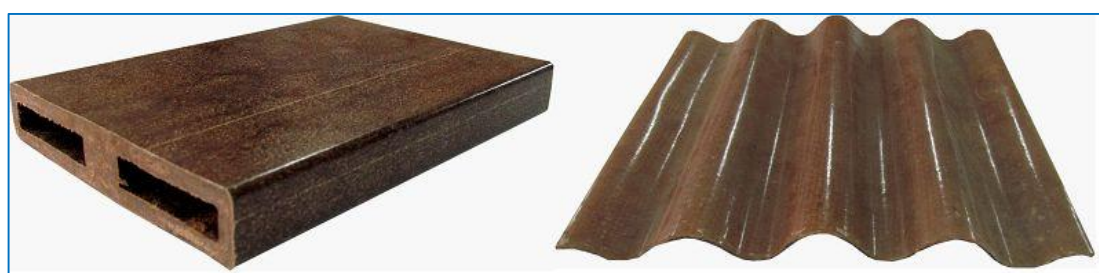
Figure 2.3 : Composites thermoplastiques renforcés avec les fibres de bambou [SUH 13].
