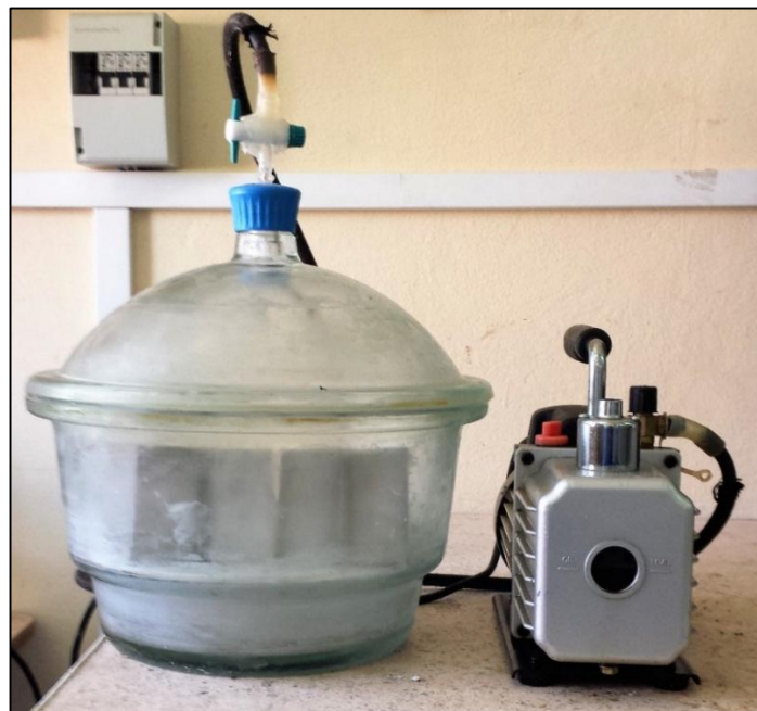
Figure 3.13 : Essais de porosité accessible à l'eau (Laboratoire EOLE, Université Abou Bekr Belkaid, Tlemcen, Algérie)
