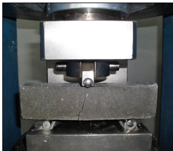
Figure 3.14 : Eprouvette et essais de traction par flexion 3 points (Laboratoire EOLE, Université Abou Bekr Belkaid, Tlemcen, Algérie).
