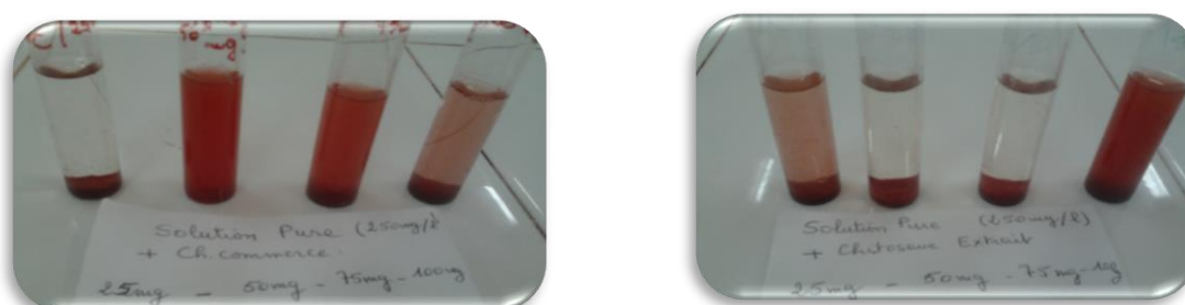
Figure 25 - L'action chélatante du chitosane du commerce et extrait vis-à-vis du rouge d'alizarine à 250mg/l. (original).
