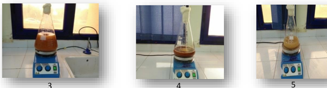
Figure 7 - (3) Etape de déminéralisation ; (4) E. de déprotéination ; (5) E. de désacétylation. (Original)
