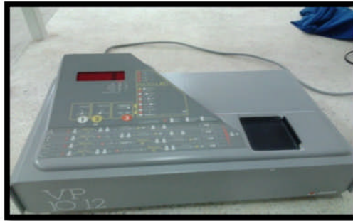
Figure III.7. Appareil de mesure du spectrophotomètre ;(laboratoire du département d'hydraulique université de Tlemcen).
