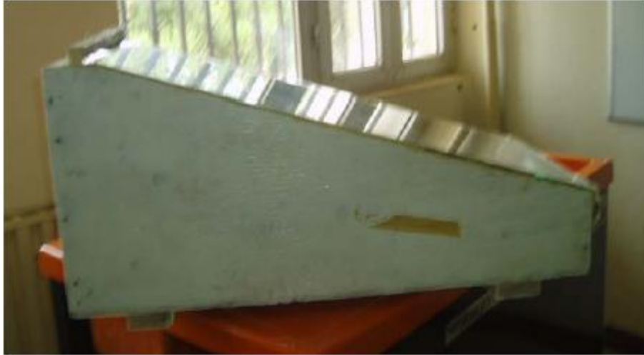
Figure IV.3 : distillateur simple effet avec une isolation en bois bien sec peint en blanc
