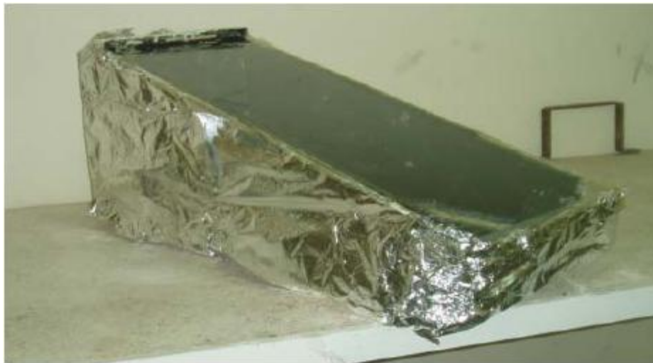
Figure IV.4 : distillateur simple effet avec une isolation en bois bien sec peint en blanc et couvert d'une feuille d'aluminium déposée sur du plastique transparent.
